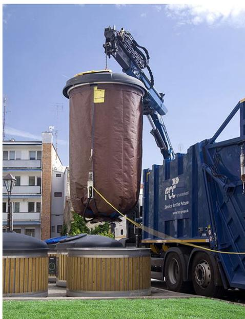
**Abbildung 13: Müllimer im unterirdischen Container**
