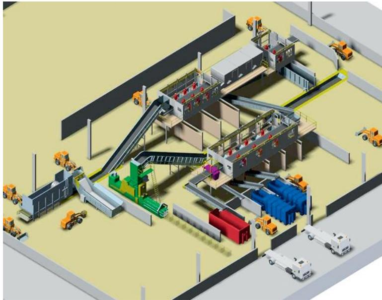
**Abbildung 7: Produktionslinie zur Herstellung von festen alternativen Brennstoffen**
