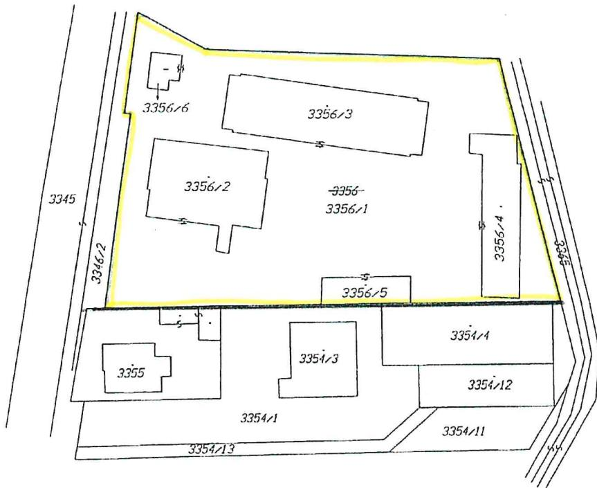
Geometrický plán je podkladom na právne úkony, keď údaje doterajšieho stavu výkazu výmer sú zhodné s údajmi platných výpisov z katastra nehnuteľností
